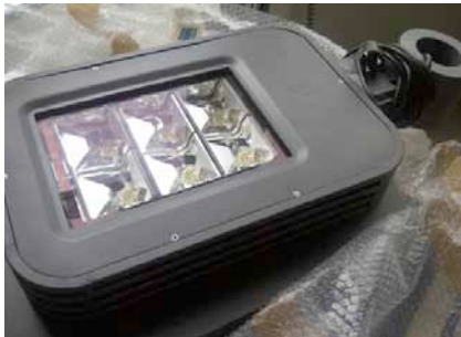
Abb. 2: CoLight Pilotleuchte - Leuchtenkopf mit Blick auf die Lightengine (LED-Kassette) [Foto: Jenoptik Polymer Systems GmbH]
