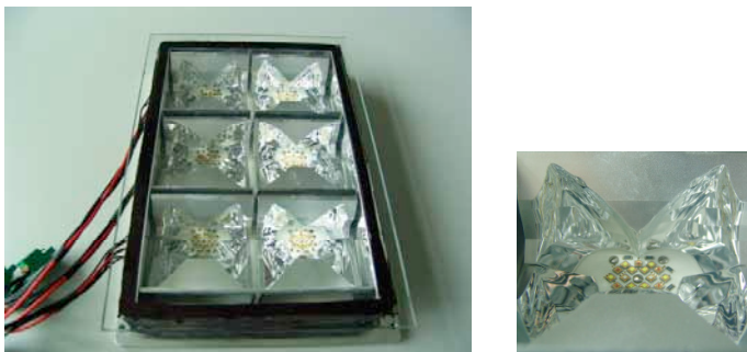
Abb. 1: Links: eine CoLight-Kassette; rechts: das LED-Cluster mit Freiformreflektor
