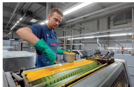
Abb. 7: Links: Druckmaschine Speedmaster XL75 der Firma Heidelberger Druckmaschinen AG (Bildquelle: www.heidelberg.com ), Rechts: Einspachteln der Druckfarbe in das Druckwerk (Farbkasten) (Bildquelle: BG ETEM)
