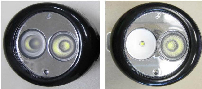
Abbildung 1: Testleuchte V01 mit zwei LEDs jeweils kombiniert mit glänzendem Reflektor und leicht streuender Linse (links), Testleuchte V02 mit zwei LEDs, wobei eine mit glänzendem Reflektor und leicht streuender Linse und die andere mit weißem Reflektor ausgelegt ist (rechts)
